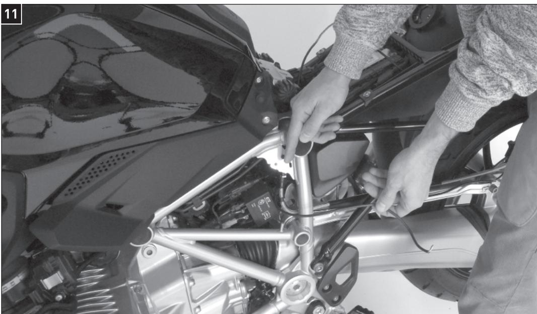
Verlegen Sie das Stromkabel auf der linken Seite des Fahrzeugs, wie in der Abbildung gezeigt.
