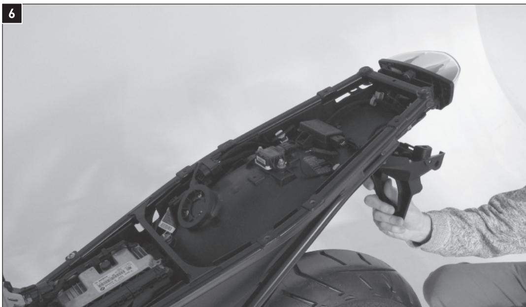
Lösen Sie die Verschraubung und entfernen Sie die Kennzeichenhalterung vom Fahrzeug.
