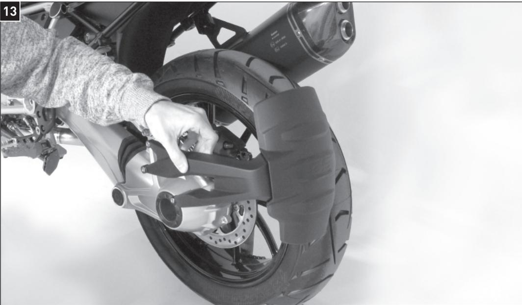
Lösen Sie die Verschraubung und entfernen Sie den Spritzschutz vom Fahrzeug.
