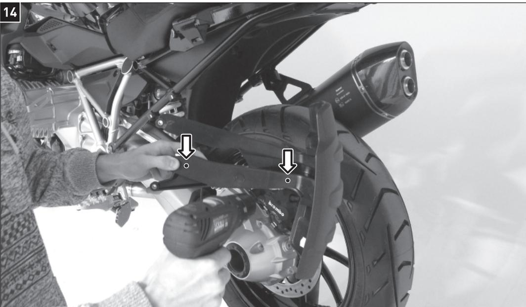
Verwenden Sie einen 8,5-mm Bohrer um die Löcher zur Kabeldurchführung in den Spritzschutz zu bohren.
