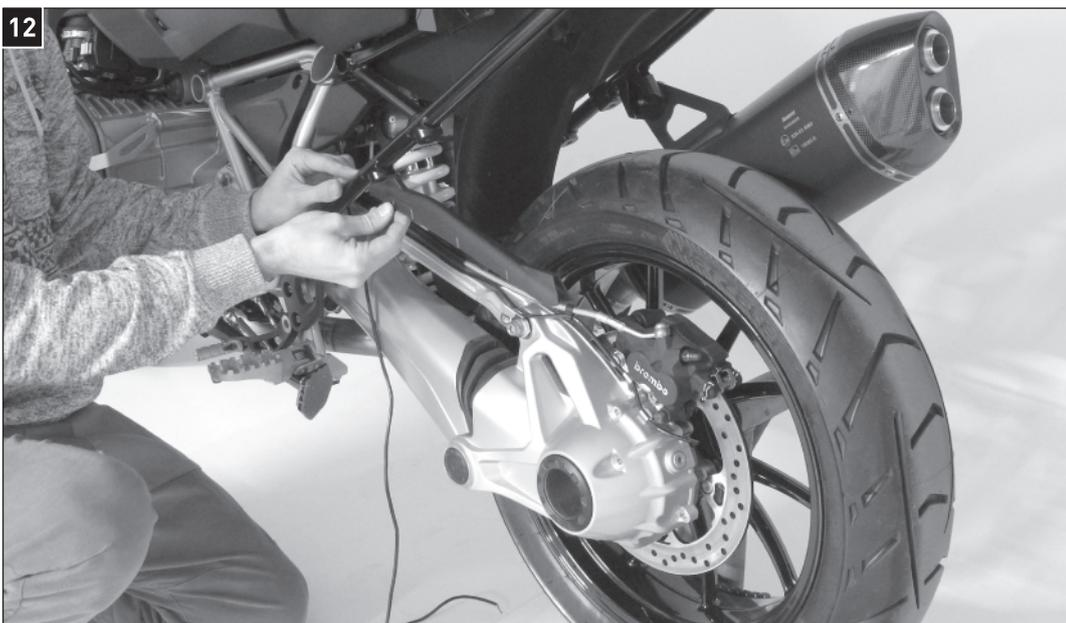
Verlegen Sie das Stromkabel zusammen mit dem ABS-Kabel unter der Kunststoff-Schiene.
