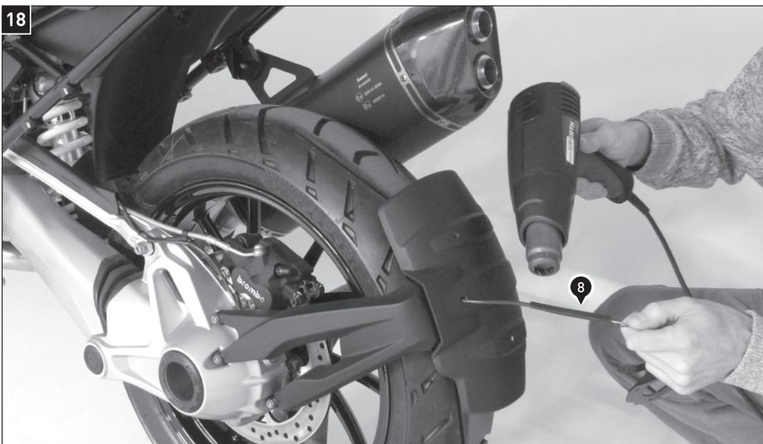
Verwenden Sie einen Heißluftföhn um den Schrumpfschlauch (8) über den Steckverbindern zusammen zu schrumpfen.
