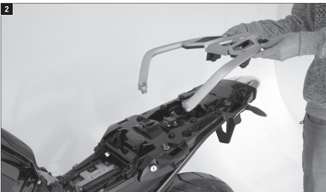
Lösen Sie die Verschraubung der Gepäckbrücke und entfernen Sie diese vom Fahrzeug, wie in der Abbildung gezeigt.
