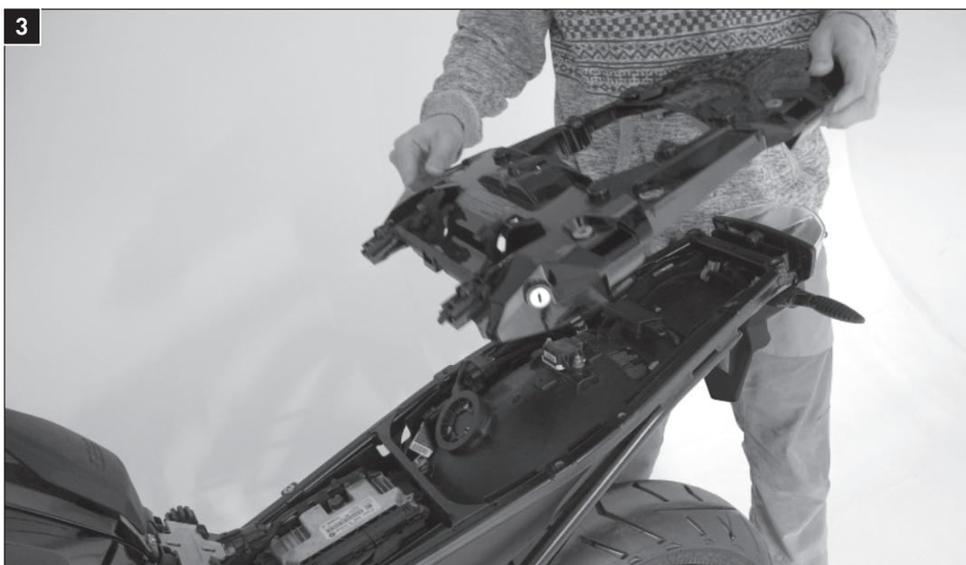
Entfernen Sie die Verkleidung des Heckrahmens, wie in der Abbildung gezeigt.
