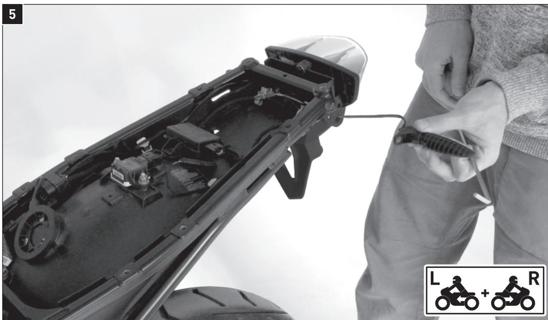
Entfernen Sie auf beiden Seiten des Fahrzeugs die Blinker, wie in der Abbildung gezeigt.
