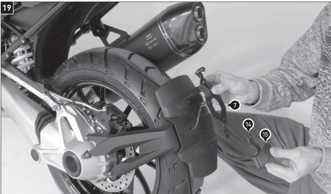
Montieren Sie den Kennzeichenträger (7) mit dem Reflektorblech (14) und dem Reflektor (15) am Spritzschutz, wie in der Abbildung gezeigt.
