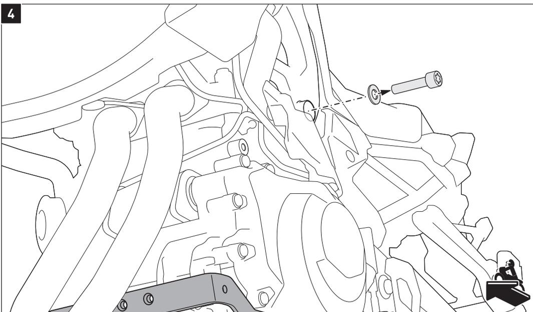
Entfernen Sie die original Motorhalteschraube auf der linken Fahrzeugseite.
