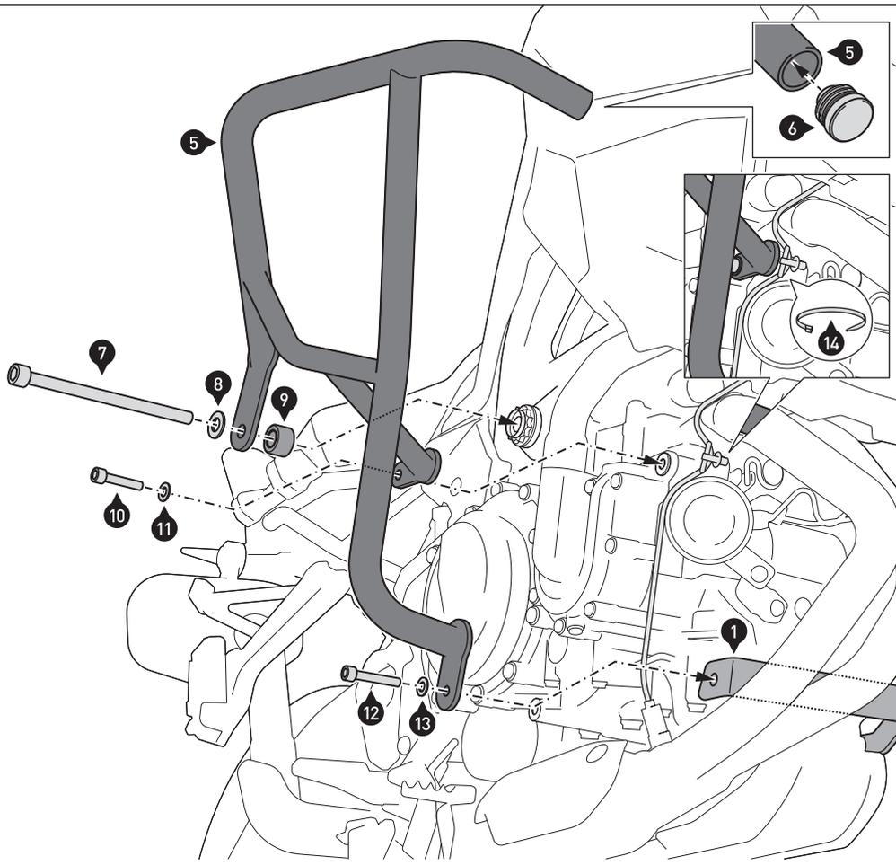
Setzen Sie den Kunststoffstopfen (6) in den Sturzbügel (5) ein.
