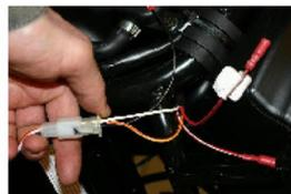
REPOSITIONNER LE PASSE FIL POUR PROTÉGER L'ENTRÉE DU CARTER ET FIXER LA GAINÉ DU STATOR LE LONG DU CHASSIS COMME D'ORIGINE AVEC DES COLLIERS PLASTIQUES NEUFS ET BRANCHER LE CONNECTEUR 4 VOIES DU STATOR MILLÉNIUM AVEC LE CONNECTEUR DU FAISCEAU.
