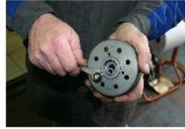
REMONTER LES 3 ERGOTS DE POMPE A EAU AVEC UNE CLÉ PLATE DE 10 SUR LE ROTOR MILLÉNIUM.
