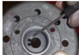
PRÉSENTER LE ROTOR SUR LE VILBREQUIN EN PLACANT LA RAINURE "A" SUR LA CLAVETTE DU VILBREQUIN
