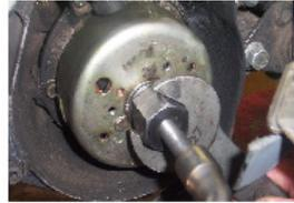
POSITIONNER L'EXTRACTEUR MBK ET YAMAHA, EXTRAIRE LE ROTOR A L'AIDE DES CLÉS CORRESPONDANTES.
