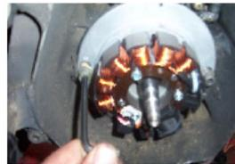
PASSER LA GAINÉ DE L'ALLUMAGE MILLÉNIUM PAR LE TROU DU CARTER D'ORIGINE ET POSITIONNER LA PLATINE EN PRÉSENTANT UNE VIS DE FIXATION D'ORIGINE SUR LE TROU REPERE "H" DE LA PLATINE, PRÉSENTER LA SECONDE VIS ET SERRER L'ENSEMBLE AVEC UNE CLÉ ALLEN DE 5.
