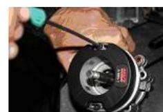
Fixer le stator à l'aide des 2 vis Allen 5x30 fournies et de leurs rondelles.
