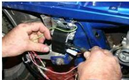
Brancher le câble haute tension d'origine avec la protection étanche fournie.
