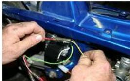
Connecter le câble jaune du stator avec le jaune du faisceau.
