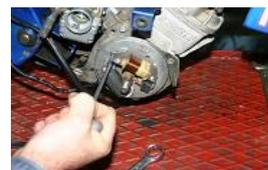
Déposer les vis de fixation du stator.
