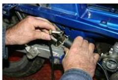
Déposer la bobine haute tension d'origine.
