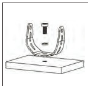
Fixer le support de montage dans la position sélectionnée
