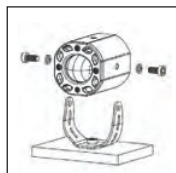
Installer le corps de lampe sur le support fixe
