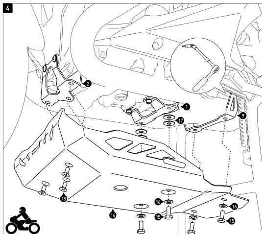
Verschrauben Sie den Motorschutz (14) locker an den Anbaublechen (1), (2) und (9). ACHTUNG: Verwenden Sie flüssige Schraubensicherung! Wenn die Anbauteile spannungsfrei
