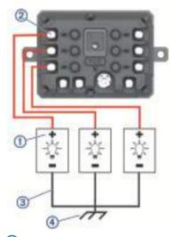
2 Branchez le fil négatif ou de masse ③ à une borne de masse non peinte ④ sur le châssis du véhicule, à un bloc de distribution de masse ou directement à la borne négative de la batterie.
