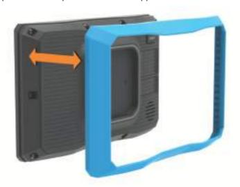
3 Placez la nouvelle bordure sur l'appareil et clipsez-la.
