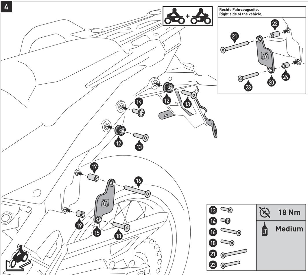
Verschrauben Sie die Führungsbolzen (12) und Befestigungslaschen (15) und (20) am Fahrzeug, wie in der Zeichnung und Detailzeichnung gezeigt.
