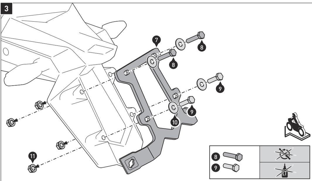
Verschrauben Sie den Querverbinde (7) am Kennzeichenhalter, wie in der Zeichnung gezeigt. Ziehen Sie die Schrauben noch nicht an.
