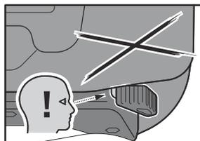
SICHTBARE ROTE MARKIERUNG: NICHT korrekt verriegelt! Verlustgefahr!
