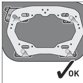
**Schritt [1]:** Setzen Sie die vier Arretierungsöffnungen des Seitenkoffers (1) auf die Führungsbolzen des montierten SW-MOTECH Seitenträgers.
