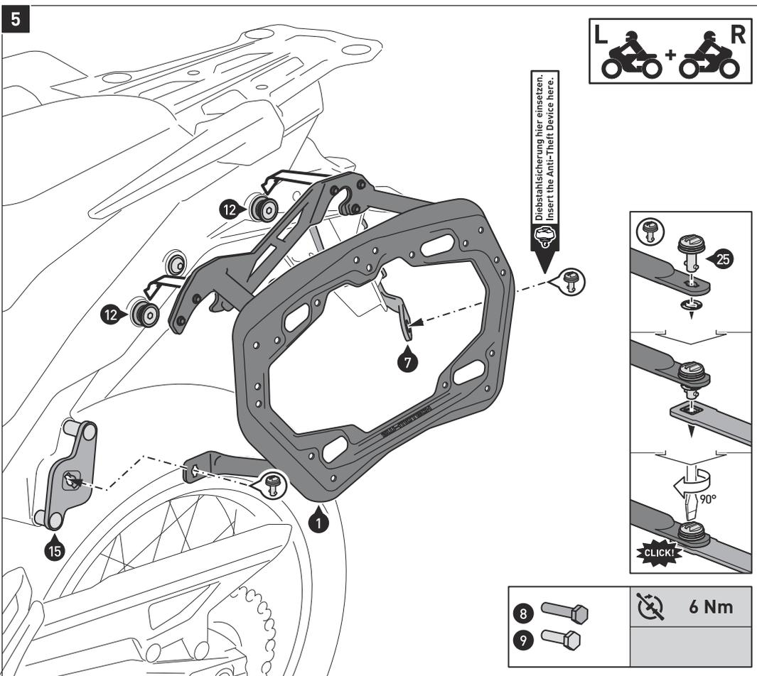
Hängen Sie beidseitig die Seitenträger (1) und (2) an die Führungsbolzen; drücken Sie die Seitenträger leicht nach unten, bis diese fest sitzen.
