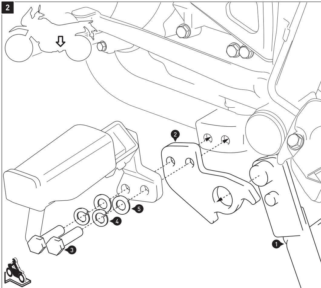
Verschrauben Sie die linke Fußraste mit dem Anbaublech (2) am Fahrzeug, wie in der Zeichnung gezeigt.
