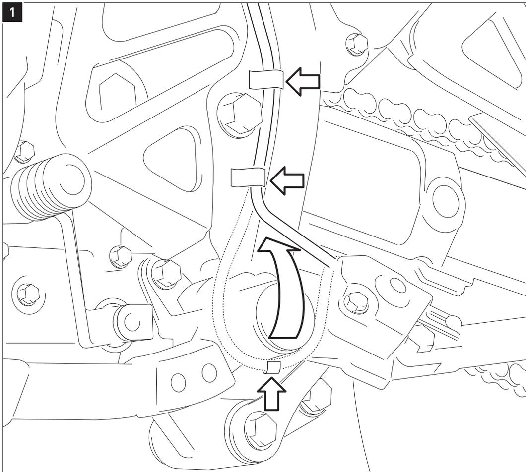
Entfernen Sie die Fußrasten beidseitig vom Fahrzeug.
