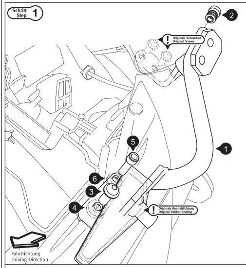
Entfernen Sie die Sitzbank und die originalen Haltegriffe vom Fahrzeug. Montieren Sie anschließend die Haltegriffe (1), wie in der Zeichnung gezeigt.
