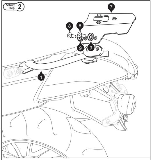
Verschrauben Sie das ALU-RACK (7) auf den Haltegriffen (1) wie gezeigt. Sichern Sie die Schrauben (8) mit flüssiger Schraubensicherung. Anzugsmoment für die Schrauben (8): 20 Nm.
