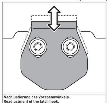
Nachjustierung des Vorspannwinkels. Readjustment of the latch hook.
