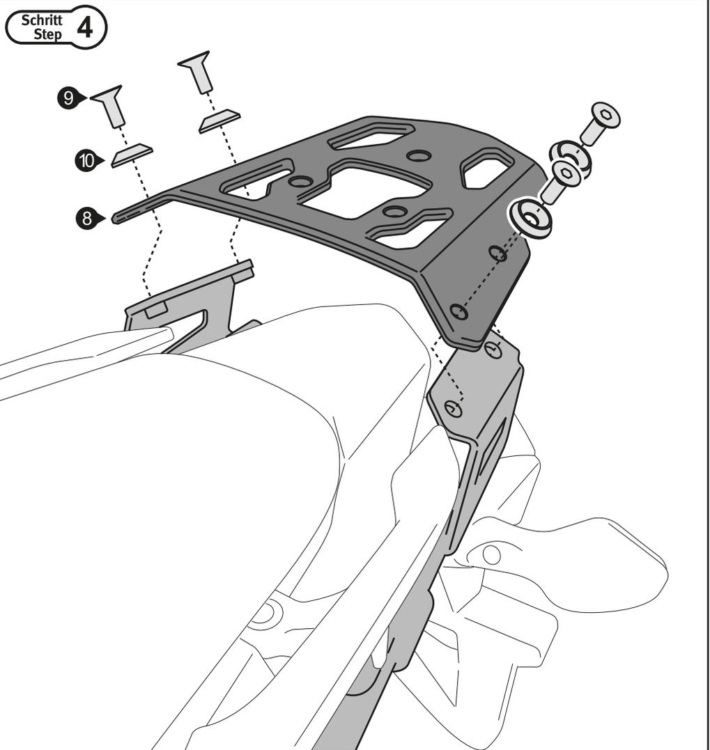
Verschrauben Sie das ALU-RACK (8) auf den Rohrstreben (2) wie gezeigt. Sichern Sie die Schrauben (9) mit flüssiger Schraubensicherung. Ziehen Sie nun die Schrauben (9) an. **Achten Sie auf das Anzugsmoment der Schrauben (9): 20 Nm.** Ziehen Sie anschließend die Schrauben (5) mit dem folgenden Anzugsmoment an: **23 Nm.**
