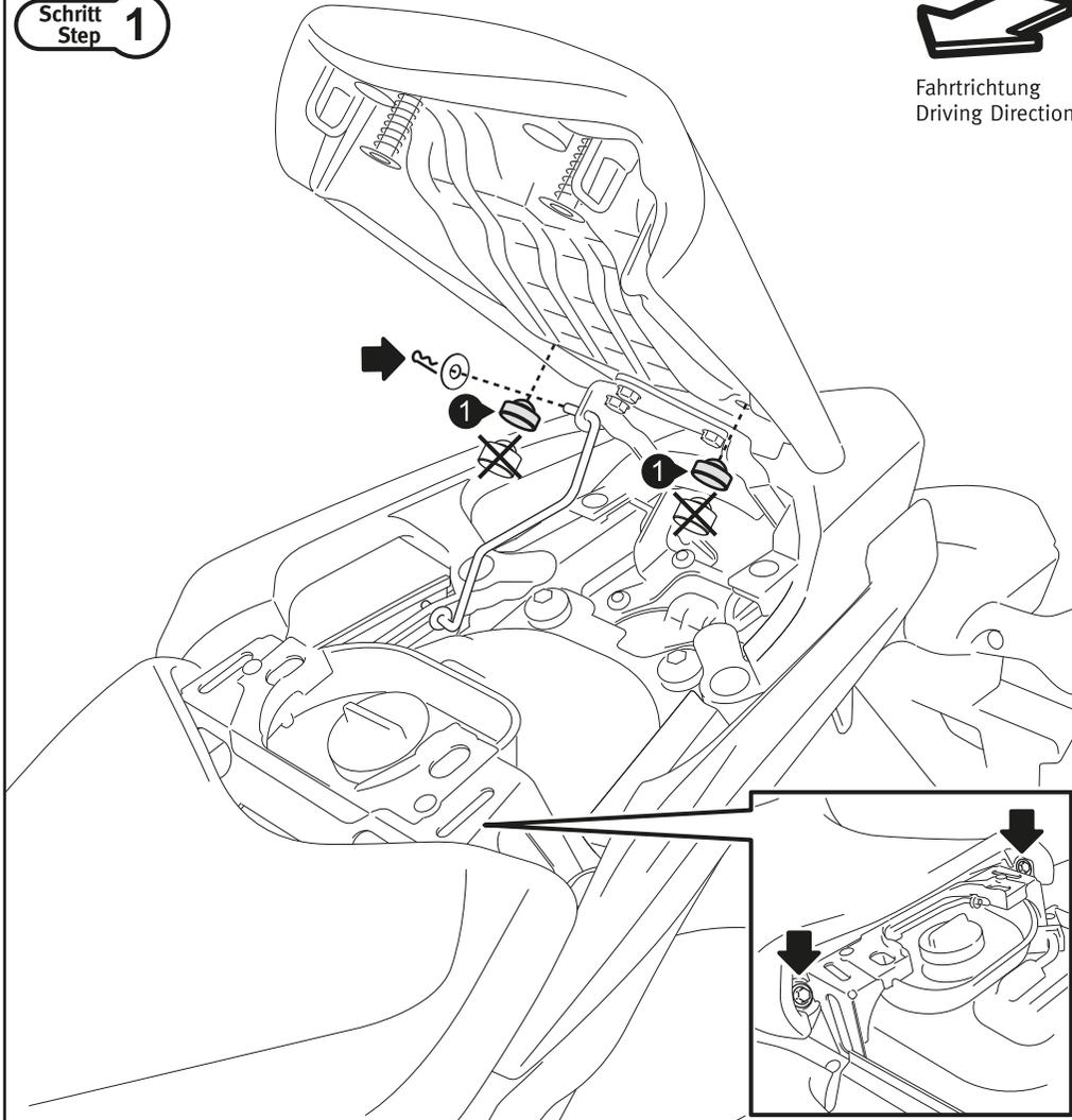
Öffnen Sie die Soziositzbank. Entfernen Sie die gezeigten originalen Sitzbank-Gummis und ersetzen Sie diese durch die Sitzbank-Gummis (1).
