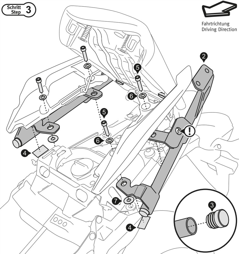
Setzen Sie die Kunststoffstopfen (3) in die vier Endöffnungen der Rohrstreben (2) ein (siehe Detailbild). Verschrauben Sie anschließend die Rohrstreben (2) mit den Sozius-Haltegriffen am Fahrzeug. **Sichern Sie die Schrauben (5) mit flüssiger Schraubensicherung.** Ziehen Sie die Schrauben (5) noch nicht an.
