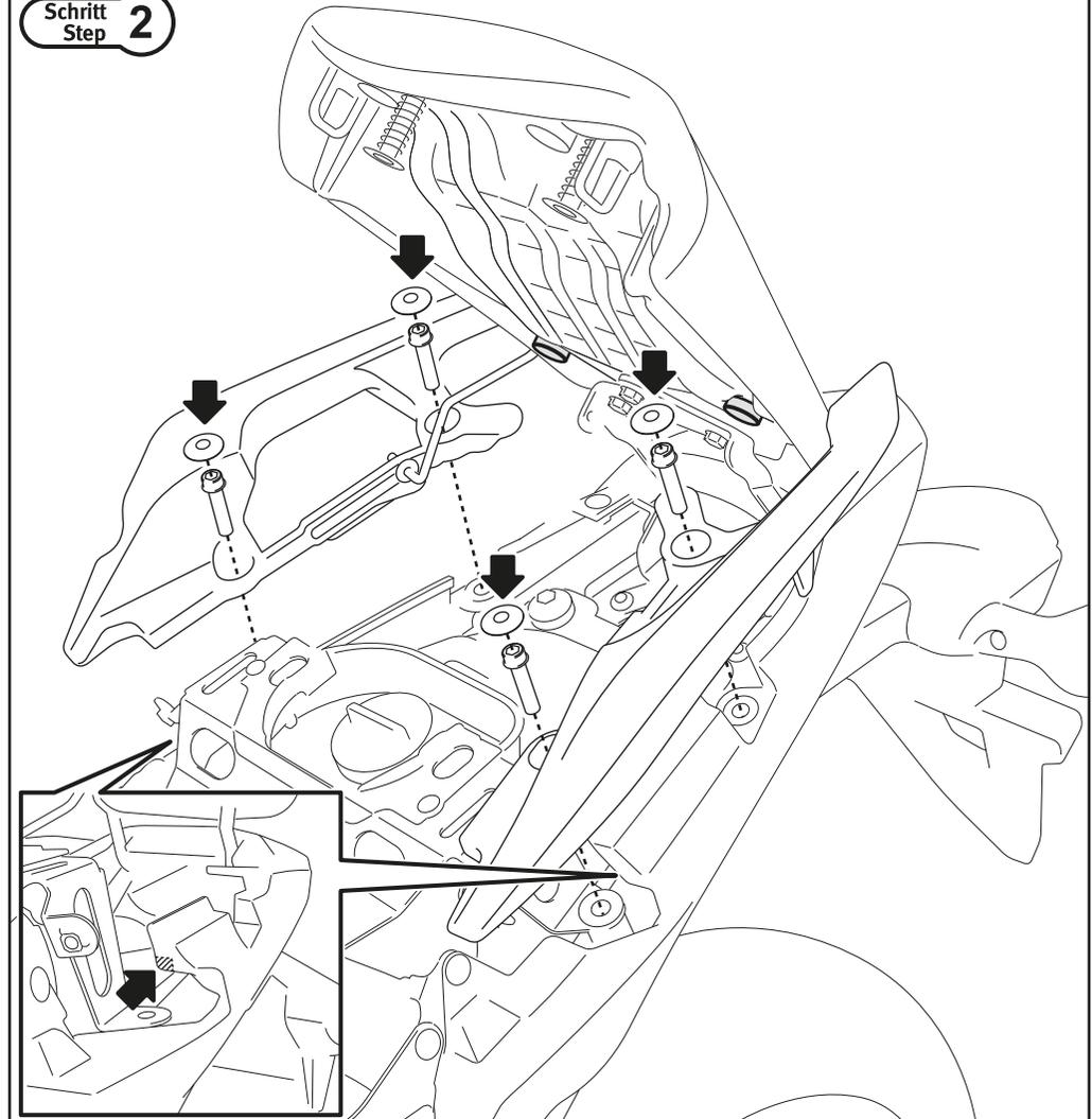
Entfernen Sie die Kunststoffabdeckungen und die originalen Schrauben der Sozios-Haltegriffe. Entfernen Sie anschließend vorsichtig die Sozios-Haltegriffe vom Fahrzeug.
