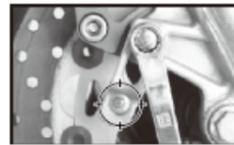
Réglez la position de support de capteur pour que le capteur soit en face de l'aimant pour éviter un mauvais signal de vitesse ou une absence de signal.
