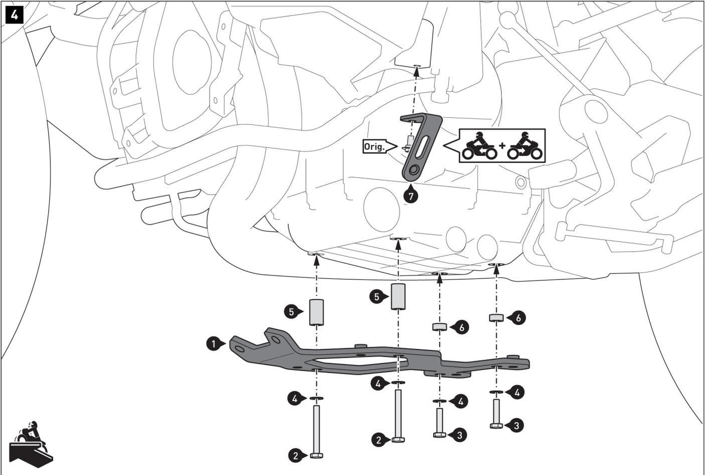
Vissez la plaque de montage inférieure (1) et les équerres de montage (7) au véhicule.
