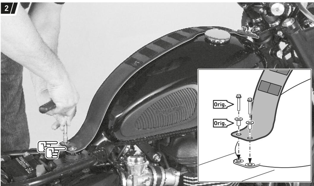
Verschrauben Sie anschließend den Tankriemen (1) mit den originalen Schrauben und Bundbuchsen (Orig.) am Tank.
