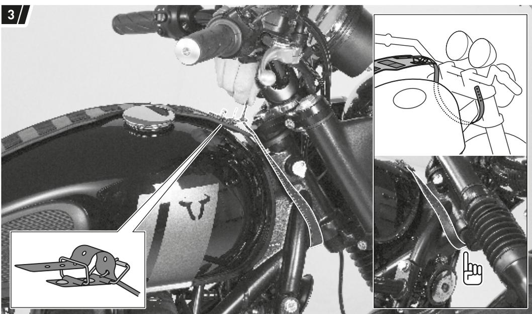
Legen Sie den vorderen Befestigungsgurt des Tankriemens (1) um den Lenkkopf des Fahrzeugs, wie in der Zeichnung gezeigt.
