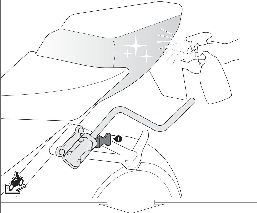
**DE** - Nachdem Sie die Abstandsbügel an Ihrem Fahrzeug montiert haben, müssen Sie die Auflageflächen der Satteltaschen mit der beige packten Lackschutzfolie (2) bekleben, um Beschädigungen zu vermeiden. Reinigen Sie die zu beklebende Fläche vor dem Aufbringen der Lackschutzfolie gründlich von Fett- und Schmutzrückständen.
