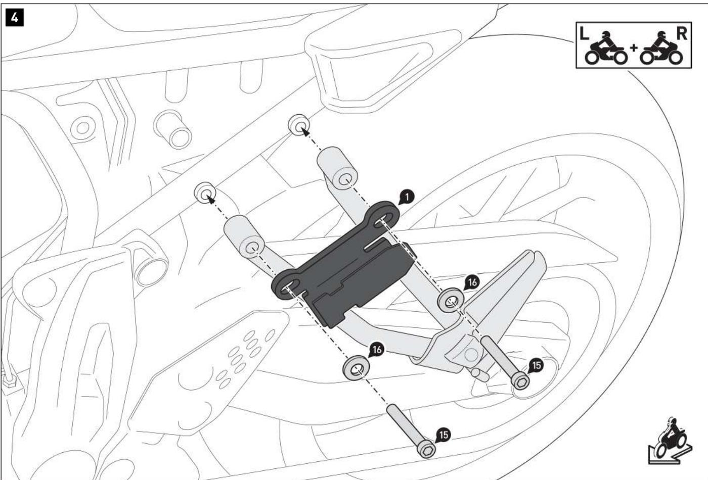
Vissez les plaques de montage [1/2] sur le véhicule.
