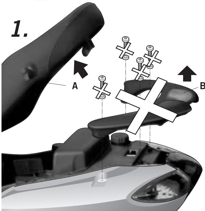
(E) Abrir el asiento (A). Desmontar y desestimar el agarradero trasero (B), mediante los tornillos y las arandelas. Nota: los tornillos y arandelas, se desestiman.
