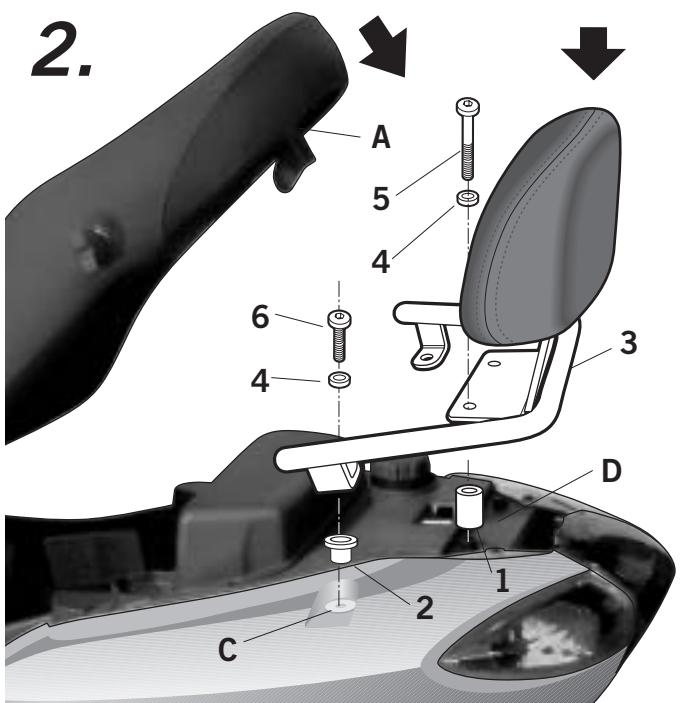
(E) Colocar los distanciadores (1) en zona (D) y los distanciadores (2) en zona (C). Montar el KIT RESPALDO (3) en zona (D), mediante los distanciadores (1), las arandelas (4) y los tornillos (5) y en zona (C), mediante los distanciadores (2), las arandelas (4) y los tornillos (6). Cerrar el asiento (A).
