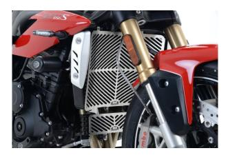
Le kit doit contenir : 1x Protection radiateur 2x 100mm Longueurs de mousse 1 x Colliers de serrage
