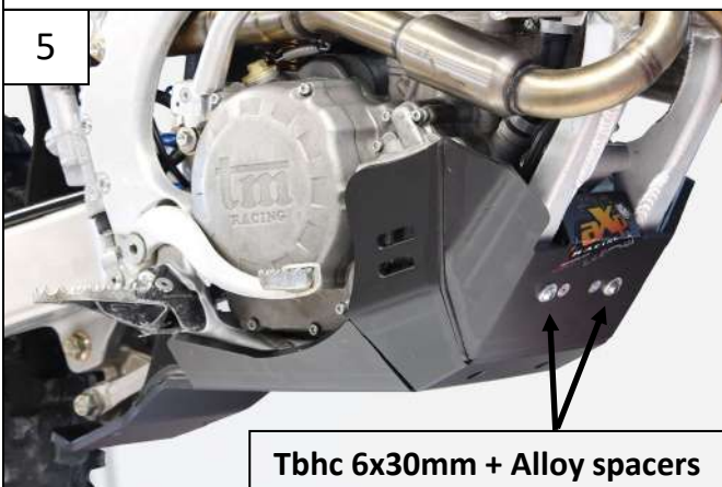
Push the skid plate to the top (3) and the to the front to engage the rear plastic mounts (4) Pousser le sabot vers le haut (3) et ensuite vers l'avant pour enclencher les crochets arrières (4)
