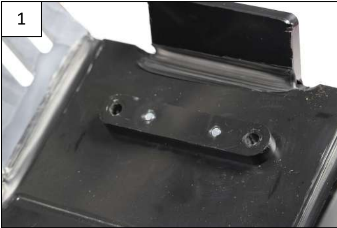
Fix the plastic part by auto drilling with the Tfhc 6x16mm Fixer la pièce plastique par autoperçage avec Tfhc 6x16mm
