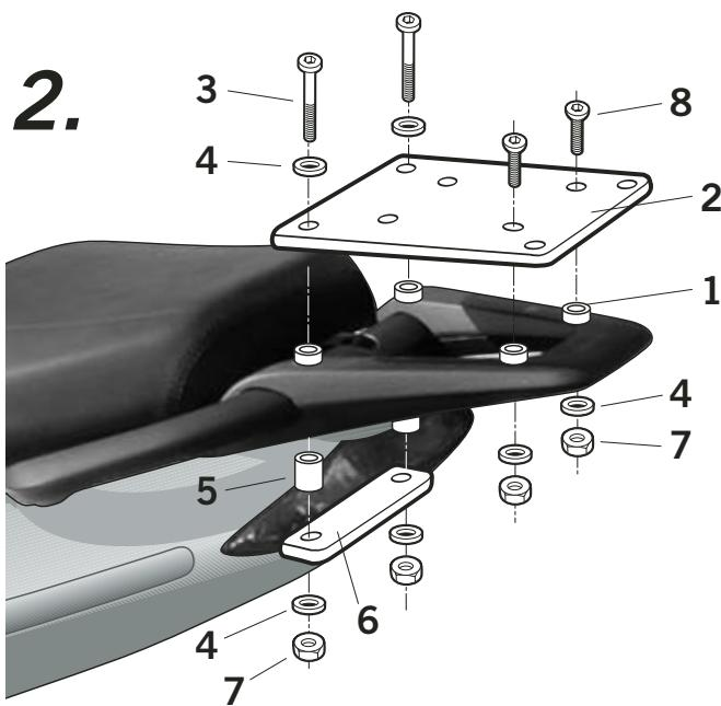
(E) Colocar los distanciadores (1). Montar el soporte KIT TOP (2), fijarlo en zona delantera mediante los tornillos (3), arandelas (4), los distanciadores (5), la chapa brida (6) y las tuercas (7). Y en zona trasera mediante los tornillos (8), las arandelas (4) y tuercas (7).
