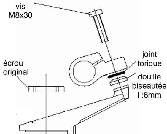
7. Posez la douille biseautée en acier inox l : 6mm (côté biseauté vers le haut), le joint torique puis la rotule du corps d'amortisseur sur l'extrémité de la patte support corps d'amortisseur. Serrez la vis M8x30 à un couple de 20 Nm.
