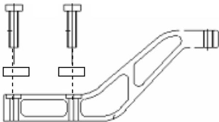
4. Dévissez les 2 vis de la fixation de réservoir.
