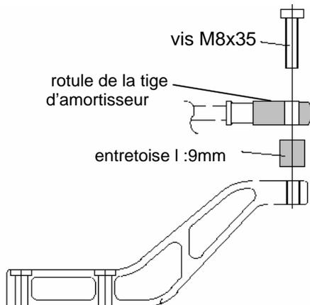
6. Posez sur l'extrémité droite de la patte l'entretoise l : 9mm, la rotule et serrez la vis M8x35 à un couple de 20 Nm.
