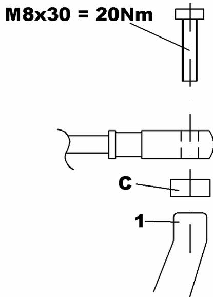
2. Fixez le collier (B) au point de fixation d'origine (2) de l'amortisseur de direction avec la vis M8x30, la douille biseautée (E) et le joint torique (F).
