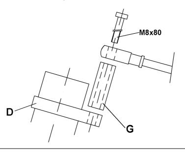
3. Fixez le collier de corps d'amortisseur (B) sur le point de fixation d'origine du réservoir d'essence (1) avec la vis M8x80, la douille biseautée (E), le joint torique (F) et la douille (H) comme indiqué ci-contre. Serrez la vis d'après les recommandations du fabricant.
