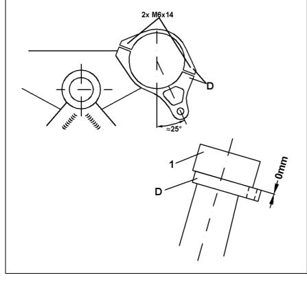
2. Montez le collier de tube de fourche (D) avec les vis M6x14 en - dessous du té de fourche supérieur (1). Positionnez le tube de fourche (D) comme indiqué cijoint. Ne serrez pas encore définitivement le collier car il devra probablement être ajusté lors du réglage de l'amortisseur.
