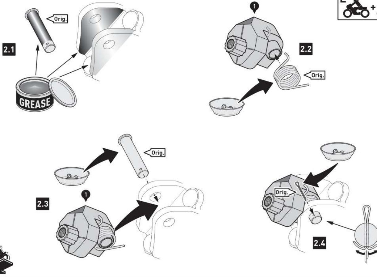
**Étape [2.1] :** nettoyez soigneusement les supports de repose-pieds. Appliquez un peu de graisse sur la partie intérieure des supports de repose-pieds et sur les boulons d'origine (Orig.).
