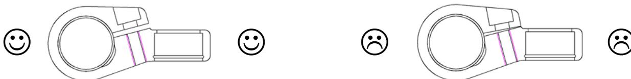
**Anzugsdrehmoment / Tightening torque / Couple de serrage M5x16 : 5 Nm**
