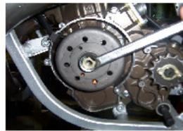
SERRER LE ROTOR A L'AIDE DE L'ÉCROU D'ORIGINE ET D'UNE CLÉ DE 15.
