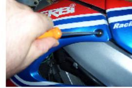
RETIRER LES 2 VIS SUPÉRIEURES DES FLANS DE RADIATEUR DROIT ET GAUCHE AVEC UN TOURNEVIS CRUCIFORME.
