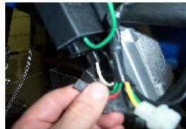
RETIRER LES CABLES DE LA BOBINE HAUTE TENSION ET DÉCONNECTER LE CONNECTEUR 2 VOIES BLANC RELIANT LE STATOR D'ORIGINE AU FAISCEAU
